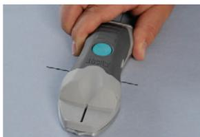
Un taglio diagonale attraverso l'angolo può aiutare a spezzare la lastra. Prendere Blade Runner e praticare un'incisione dall'angolo esterno all'angolo interno. Per spezzare il pannello, posizionare la mano sull'angolo esterno con il pollice sull'estremità superiore e le altre dita al di sotto.
